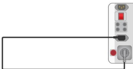
Figura 6.17: Continuità MS PE – IEC PE
