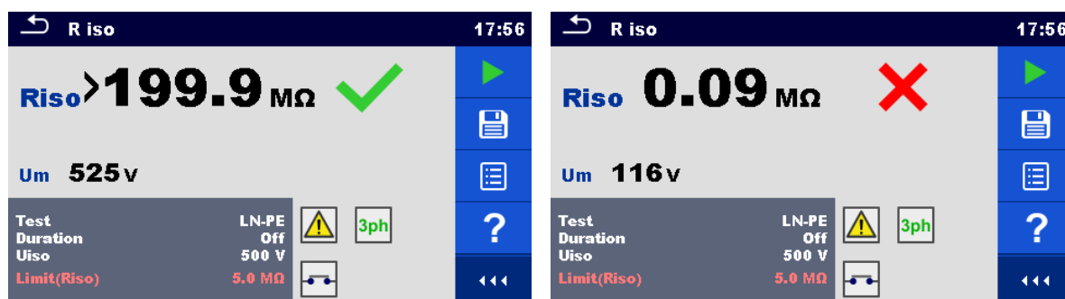
Figura 6.30: Esempi di risultati di misurazione della resistenza all'isolamento (attrezzature di saldatura)
