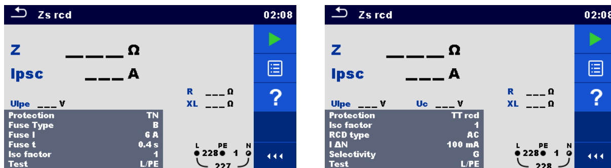
Figura 6.72: Menù Impedenza di guasto e corrente di cortocircuito prospettica
