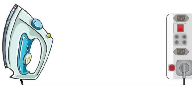
Figura 6.26: Riso di resistenza all'isolamento (presa)
