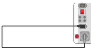
Figura 6.138: Test di polarità (manuale)
