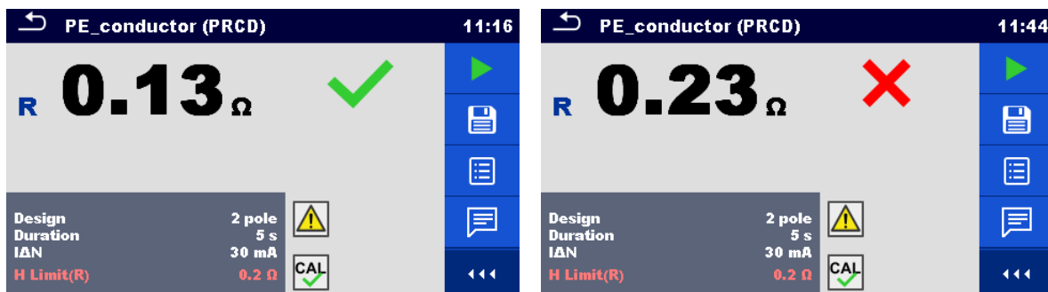
Figura 6.120: Esempi di risultati del conduttore PE (PRCD)
