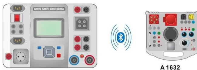
Figura 8.4: Collegamento dell'analizzatore di eMobility (A 1632)
