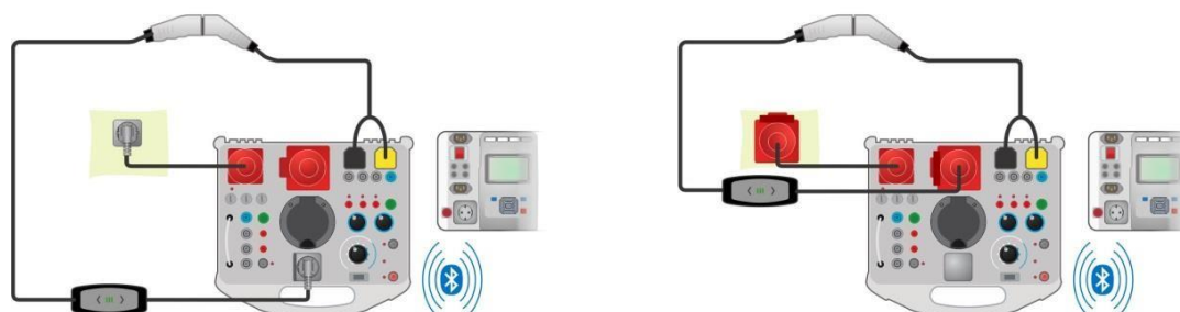
Figura 6.105: Test diagnostico - Simulatore EV e sotto-errori sotto-test - collegamento alla modalità 2 cavo di ricarica alimentato da Analyser
