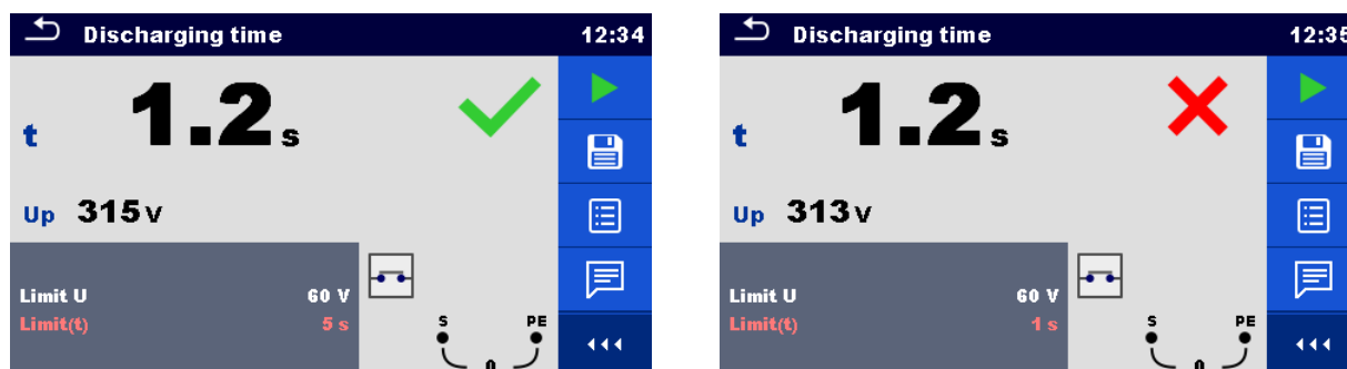
Figura 6.149: Risultati dei test di tempo di scarico
