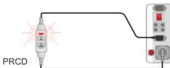
Figura 6.119: Test del conduttore PE (PRCD)
